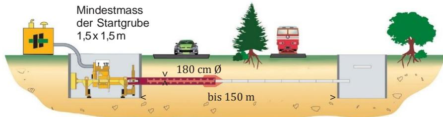
Mit unserem Pressbohrsystem verlegen wir Rohre für den Abwasser- und den Strassenbaubereich bis 180 cm Durchmesser, richtungs- gesteuert, für Einsätze bis Bodenklasse 7 (Fels).
