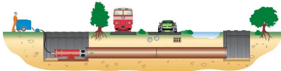
Stahlrohre Rammen bis 160 cm Durchmesser, bis Bodenklasse 6 mit hoher Präzision. Pneumatische Rammen bis 2.5 t Einsatzgewicht zum Unterqueren von Bahngeleisen, Autobahnen, Gartenanlagen usw.
