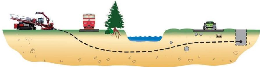
Grabenloses unterqueren von Strassen, Eisenbahnlinien, Gartenanlagen usw. bis 1000 m Länge, elektronische Überwachung des Presskopfes, für Leitungen und Rohre bis über 100 cm Durchmesser.
