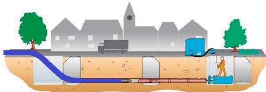
Druckrohrsanierung mit Primus Line auf eine Länge bis 2'500m für DN 150 – DN 500. Betriebsdruck bis 82 bar möglich. Stangen- und Seilberstanlagen bis 125 Tonnen Zugkraft, zum Bersten von Guss-Beton-, Stahl- und Kunststoffrohren, mit Neurohreinzug bis ca. 600 mm Durchmesser.
