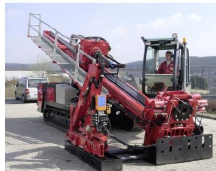
ter verfolgt und aufgezeichnet werden. In mehreren Arbeitsgängen wurde die Pilotbohrung auf 800 mm aufgeweitet. Was im kompakten Fels ausserordentlich gut funktionierte, wurde seeseitig durch eine rund 80 m starke Hangschuttstrecke, durchsetzt mit grossen Gesteinsblöcken, sehr erschwert. Dank innovativen Ideen und einem grossen, breitgefächerten Geräte- und Maschinenpark, konnte das PP-Rohr DN 630 nach erfolgter Bohrlochaufweitung, problemlos eingezogen werden. ■
